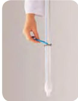
ViscoSampler, doté d'une forte puissance d'aspiration pour les fluides de forte viscosité. Le piston aspire le fluide, avant de l'expulser ensuite. En PTFE/FEP ultra-pur et chimiquement inerte pour collecter des échantillons sans contamination.
