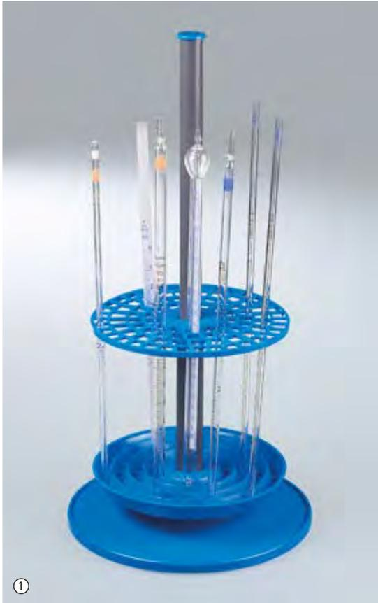
Support pour 94 pipettes de tailles différentes. Plaque à trépied avec rebord, qui retient les liquides qui s'égouttent. Les pointes sensibles des pipettes sont logées dans une plaque de support rotative avec des rainures coniques.
