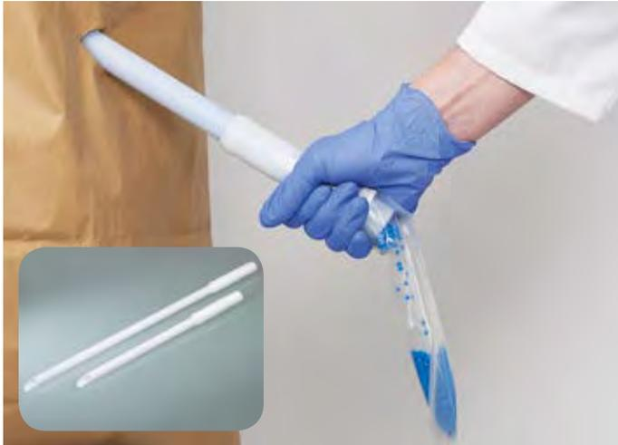
Avec l'échantillonneur à usage unique DispoLance, il est possible de prélever des quantités réduites à grandes directement dans les sacs. Le collecteur est approprié pour les poudres pouvant s'écouler et les granules à petite granularité. Avec la pointe stable, l'échantillonneur DispoLance est inséré dans le récipient, l'échantillon s'écoule via le tube intérieur directement dans le réservoir ou le sac se trouvant directement en dessous.
