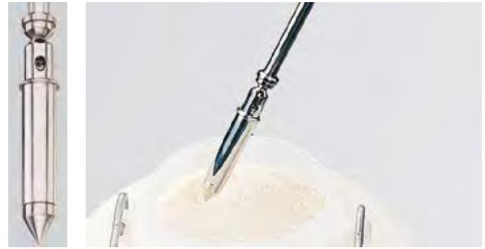
Dans le cas de poudres hautement actives et coûteuses, on collecte uniquement de faibles quantités. Le PharmaPicker permet de collecter des échantillons de 0,1 ml à 2,5 ml. Il est possible de modifier le volume de prélèvement grâce à un échange simple des pointes dans les coupelles 0,1 - 1,2 ml ou 1,25 - 2,5 ml
