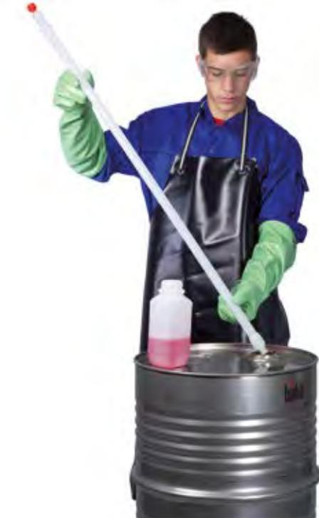
LiquiSampler, l'échantillonneur pour liquides, conforme à la norme DIN EN ISO 15528. En PTFE/FEP ou PP ultra-pur et chimiquement inerte pour un échantillonnage sans contamination. Prélèvement dans des récipients ouverts ou fermés, des fûts, des citernes, des silos, des plans d'eau. Il est adapté à tous les fûts et récipients courant avec un diamètre d'ouverture d'au moins 32 mm.
