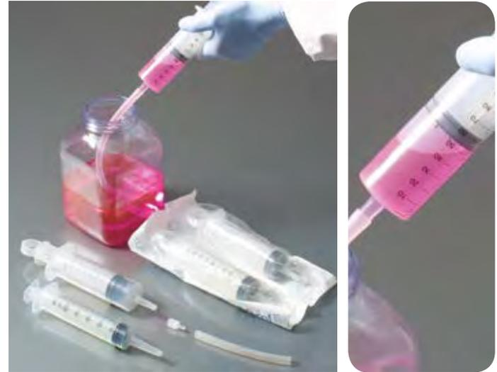
La seringue d'aspiration permet d'aspirer des liquides de façon stérile, et de les conserver ainsi. La quantité prélevée peut être consultée sur l'échelle graduée imprimée.
