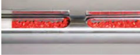
Le pic raqueur est un préleveur spécial pour les poudres et granulés non coulants. L'échantillon est amené dans le tube intérieur à obturateur à l'aide d'un bord raqueur. Grâce aux séparateurs en PTFE coulissants, le tube peut être séparé en plusieurs zones de tailles différentes. Les séparateurs empêchent également un mélange de l'échantillon.
