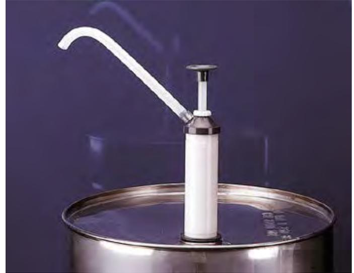
La pompe à piston est fabriquée en polypropylène et polyéthylène, pour produits aqueux et pétrochimiques. Elle offre un bon rapport qualité-prix. La pompe à piston est fixée au récipient de transvasement à l'aide d'un filetage 2" ou 3/4". Après le montage, la pompe peut tourner autour de son axe, permettant ainsi de placer les réservoirs de transvasement également sur le couvercle de fût.
