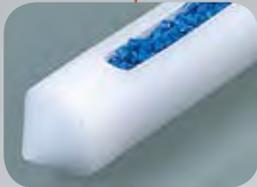
Les échantillonneurs à usage uniques ne doivent pas être nettoyés après utilisation, à la différence des échantillonneurs réutilisables.
