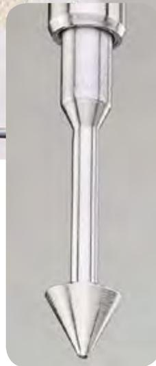
Le MicroSampler a été spécialement conçu pour collecter de petites quantités de poudre. Des volumes de 0,2 ml, 0,5 ml, 5,0 ml et 10 ml peuvent être prélevés dans les sacs ou récipients, à différentes profondeurs, de façon simple, rapide et propre.
