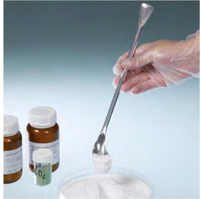
Cuillères d'échantillonnage pour le prélèvement de petites quantités d'échantillons. La forme spéciale de la cuiller permet d'atteindre le moindre recoin du fût et empêche l'échantillon de glisser de la cuiller.
