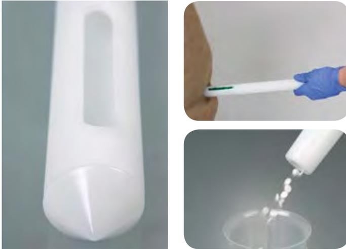
Avec TargetDispo, un échantillon ciblé est prélevé à une position précise déterminée auparavant du produit à échantillonner. Le collecteur est inséré fermé dans la poudre ou le granulé et ouvert puis refermé seulement au point de prélèvement. On obtient ainsi un échantillon ciblé exact. L'échantillon peut ensuite être vidé simplement par le biais de la poignée ouverte.
