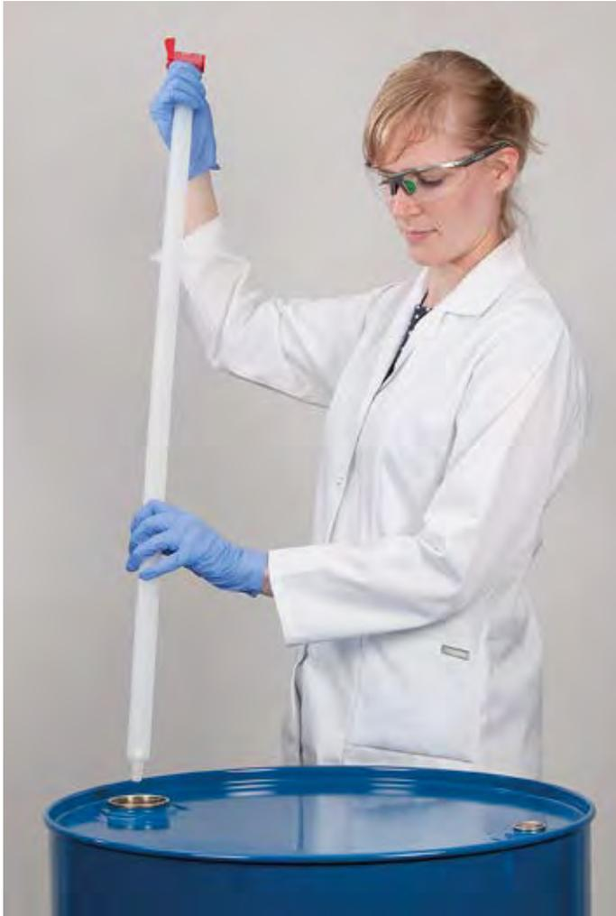
Siphon pour le prélèvement simple d'échantillons liquides. Bonne visibilité au travers des tubes transparents. Extrémité supérieure équipée d'un robinet, extrémité inférieure d'un clapet à bille.
