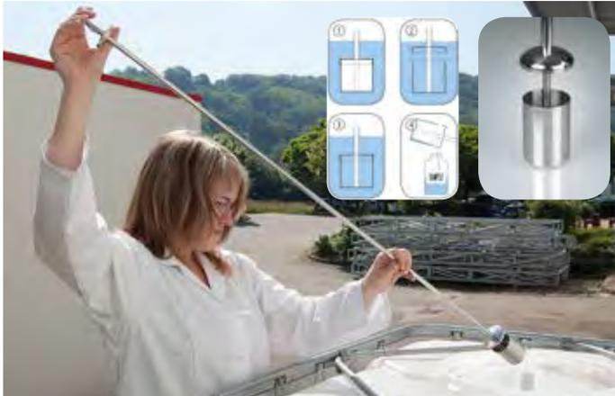
Avec le puisard à échantillons Liquid CupSampler en inox V4A, il est possible de prélever des échantillons ciblés de liquides de différentes viscosités. Même des milieux à particules peuvent être échantillonnés sans problème.
