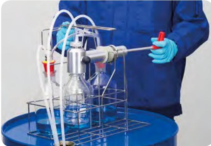
L'échantillonneur de zones Bürkle pour liquides permet de prélever jusqu'à trois échantillons ciblés, issus de différentes profondeurs d'un liquide.
