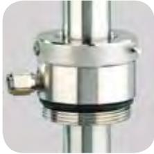
Le raccord fileté étanche au gaz empêche la sortie de gaz toxiques hors du fût. Filetage de fût acier R2", vanne anti-retour avec raccord 1/8". Laiton nickelé, joints en FKM.
