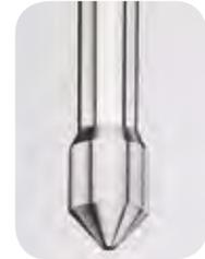
Préleveur pour substances visqueuses telles que pâtes, boues, crèmes, huiles. Le piston permet d'aspirer l'échantillon et de l'expulser directement dans le récipient collecteur. Nettoyage facile pour un prélèvement inégalé. Selon le degré de viscosité, la pointe d'aspiration dévissable peut être livrée avec un perçage de 2 à 6 mm.
