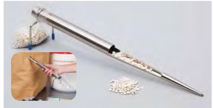
Echantillonneur pour poudres pour le domaine pharmaceutique, en acier V4A, qualité 1.4404. La pointe particulièrement fine peut être enfoncée facilement en profondeur. La forme conique permet en outre de prélever de petites et grandes quantités d'échantillon. Stick-Proof est conçu en une seule pièce, sans angles vifs, rainures ou stries, ce qui permet un nettoyage impeccable et rapide. L'échantillon peut être directement versé dans le sachet. Fixation du sachet par une bride solide.
