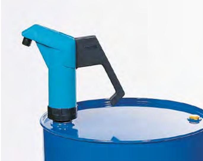
Pompe à levier compacte, auto-amorçante en polyéthylène, convient aux liquides alcalins et à de nombreux acides. Le tube d'aspiration télescopique de la pompe à levier peut être sorti sans palier jusqu'à 914 mm, ce qui permet de l'utiliser sur des fûts de 60 à 200 l.
