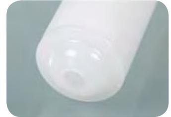
Échantillonneur simple pour le prélèvement de liquides très fluides. Si la DispoPipette est introduite ouverte dans le liquide, on obtient un échantillon toutes couches ; si elle est introduite fermée jusqu'au point de prélèvement et si elle est alors seulement ouverte, on obtient un échantillon ciblé. Utilisation très simple. Avec deux tailles d'ouverture (2,5/5,5 mm) pour les diverses viscosités.
