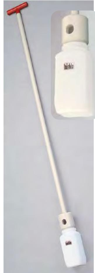
L'échantillonneur ChemoSampler a été conçu pour le prélèvement de liquides agressifs, tels qu'acides, bases, détergents, solvants. L'échantillon est directement prélevé dans le flacon original vissé. La fermeture de ce flacon avec sa bague de sécurité originale assure un transport sans contamination des échantillons. La rallonge permet de prélever des échantillons jusqu'à une profondeur de 200 cm, par exemple dans les cuves, silos ou camions-citernes.
