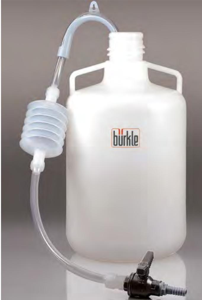
Appareils faciles à commander permettant de transvaser rapidement des liquides aqueux d'un récipient placé en hauteur dans un autre en contre-bas.
