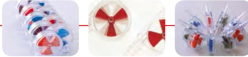
Indicateur de débit pour l'affichage de la vitesse d'écoulement exacte partout où des liquides ou des gaz sont transportés dans des tuyaux. L'indicateur de débit à roue à ailettes fonctionne dans les deux sens et dans n'importe quelle position. La roue à ailettes tourne à environ 150 ml/min (liquides).
