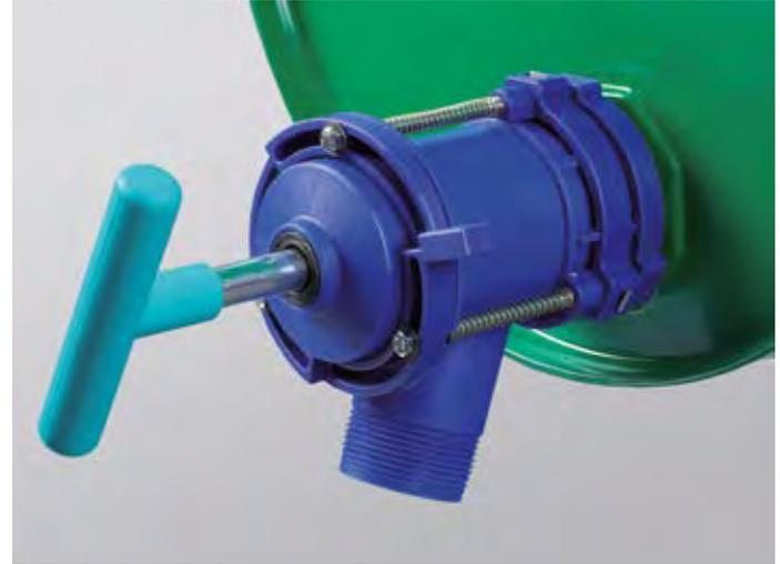
La vanne de fût permet une purge rapide et propre, même pour des liquides fortement visqueux. Elle est adaptée aux fûts métal avec raccord métallique TriSure BSP 2". La vanne de fût permet à la fois d'ouvrir le filetage de fût, mais également de purger et refermer des fûts sans avoir à les déplacer, même s'ils sont pleins ou couchés.
