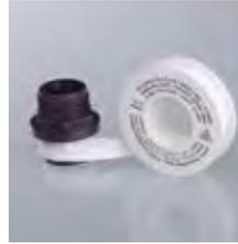
Le ruban d'étanchéité en PTFE permet d'étanchéfier des filetages de manière idéale. Faible abrasion, extrême résistance chimique, résistance thermique de -80°C à + 260°C.
