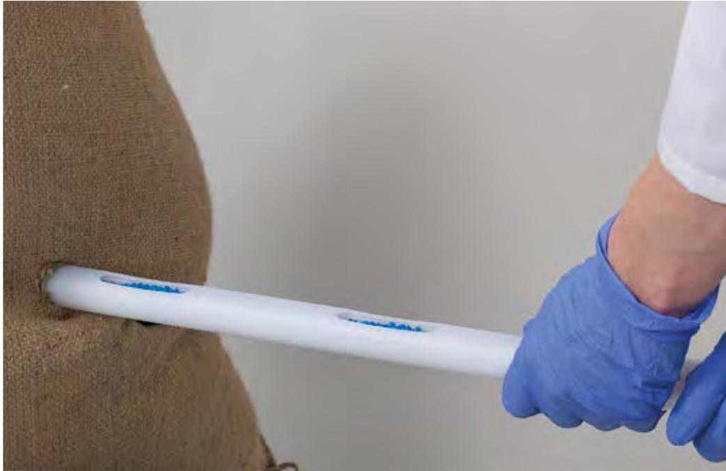
Collecteur zonal à usage unique pour le prélèvement d'échantillons de plusieurs couches du produit à échantillonner. Approprié pour les poudres pouvant s'écouler et les granulés à fine granularité. L'échantillon toutes couches représentatif peut être vidé directement à travers la poignée ouverte dans un récipient à échantillons.
