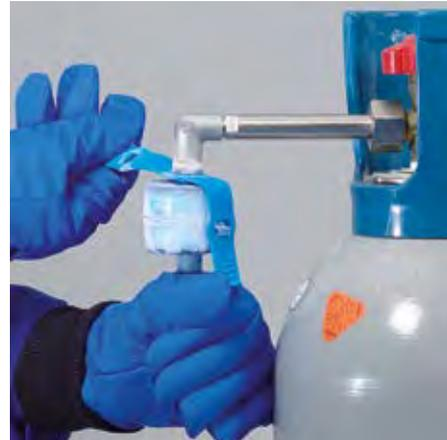
porte quelle bouteille de CO2 européenne en acier avec conduite montant sans détendeur (W 21,80 x 1/14" selon DIN 477-1 N° 6), utilisée couramment dans de nombreuses entreprises et laboratoires. Une bouteille peut sinon être louée auprès d'un commerce local spécialisé contre une somme modérée.
