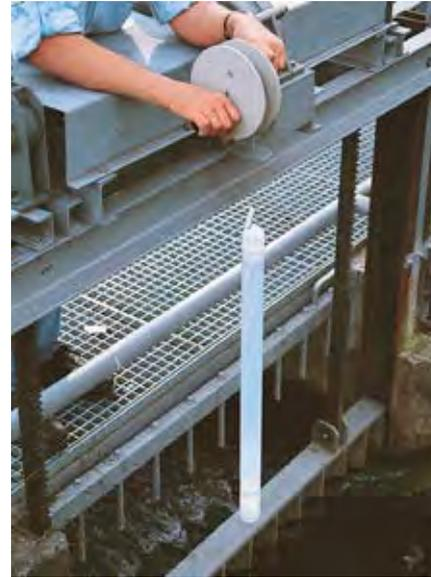
Echantillonneur pour prélèvements en eaux souterraines de fontaines, puits et autres sources. Convient à tous les puits jusqu'à 2" de diamètre, sans coincer ni rester accroché. Le matériau ultra-pur garantit la meilleure pureté possible de l'échantillon. Facile à nettoyer en raison des bords et filetages arrondis.
