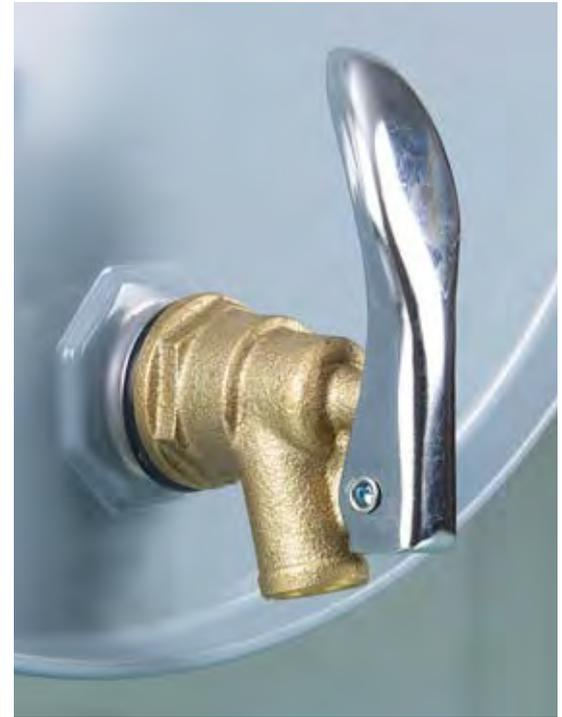
Robinet de fût pour liquides pétrochimiques, se ferme automatiquement en cas de non utilisation (sécurité accrue), raccord fileté 3/4" extérieur.
