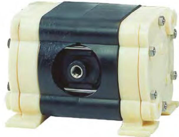
Pompe pneumatique à membrane pour transférer les fluides visqueux, corrosifs, abrasifs et inflammables. Modèle de pompe 1/4". La pompe est disponible en matériaux polypropylène, PVDF et nylon. Les membranes, billes et sièges sont disponibles en Geolast, PTFE et santoprène. Des particules solides jusqu'à 1,6 mm Ø peuvent être pompées.
