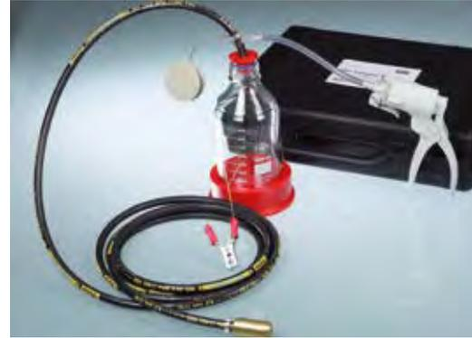
Préleveur spécialement conçu pour le prélèvement de liquides inflammables de classe de risque A1 (VbF, par ex. l'essence). Le flacon en verre et le tuyau sont raccordés de façon conductrice et sont mis à la terre par un câble de masse.
