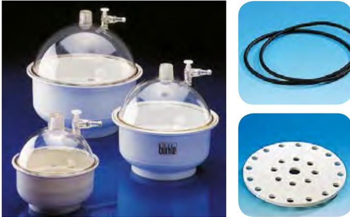
Dessiccateurs en matière plastique, incassables, légers et fonctionnant sous vide. Le robinet est adapté à un vide jusqu'à 980 mbar. Partie inférieure et insert perforé en polypropylène. Couvercle en polycarbonate transparent avec clapet anti-retour et vanne de purge. Etanchéification par joint torique en caoutchouc polychlorobutadiène. Température en service continu + 60 °C maxi.
