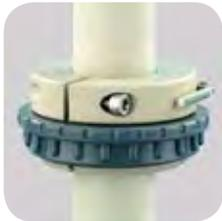
Filetage de réservoir pour la fixation de la pompe vide-fût sur la paroi du réservoir ou dans les bouchons à vis à col large. Le filetage 2" est fixé de l'intérieur avec le contre-écrou 2". (Orifice de montage dans le réservoir 60 mm).
