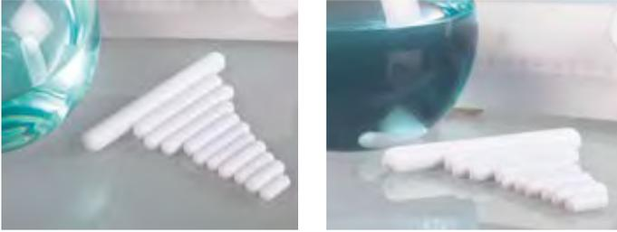
Barreaux magnétiques cylindriques avec surface lisse, multi-usages.
