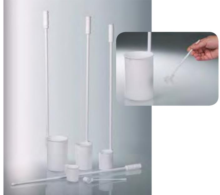
Toutes les pièces en contact avec le milieu sont en PTFE pur, blanc. Totalement inerte contre toutes les substances (à l'exception du fluor élémentaire). La tige est stabilisée avec un noyau métallique et entièrement blindée de PTFE. Longue de 60 cm, la tige peut être prolongée d'un élément supplémentaire de 120 cm de long. Le puits en PTFE d'une capacité de 10 ml est muni d'une tige rigide de 155 mm de long.
