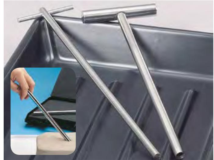
Tarière creuse cylindrique avec couronne de coupe, permet une insertion aisée dans les substances pâteuses et semi-dures. Les échantillons retirés sont ensuite expulsés à l'aide de la tige fournie. Longueur totale 260 mm. Diamètre intérieur 8 mm, diamètre extérieur 10 mm.
